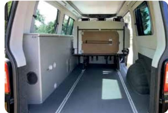
46 cm Stauraumhöhe bei heruntergeklappter Heckablage. Bei hochgeschwenkter Heckablage misst der Kofferraum: B 120 x T 85 cm, ca. 690 l. Die Sitzbank kann über die Schienen bis hinter die Fahrerhausitze geschoben werden, dadurch entsteht ein Kofferraumvolumen von ca. 4800 l (kurzer Radstand) u. 5800 l (langer Radstand).
