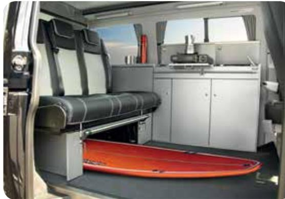
Bei abgenommener Sitzbankblende ergibt sich eine Durchlademöglichkeit bis max. 2,4 m Länge hinter den Fahrersitzen, zwischen den Fahrersitzen sogar bis 3,5 m. Perfekt für langes Transportgut wie Skier, Surf- und Snowboards. Die Höhe unter der Bank beträgt 31 cm, die Breite 60 cm.
